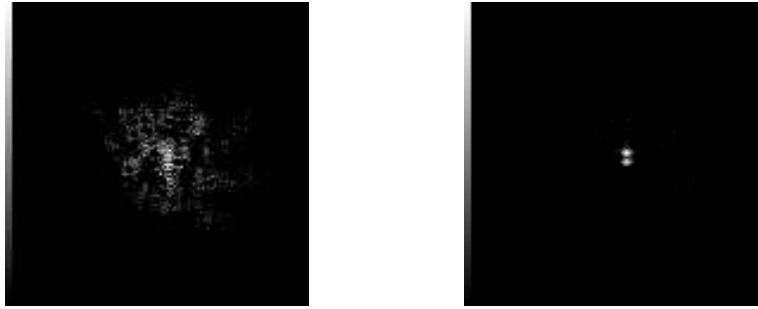
FIG. 10.6 – Images expérimentales de Capella déconvoluées : à gauche, estimation des fronts d’ondes par MAP puis déconvolution quadratique ; à droite, déconvolution myope. Dans les deux cas, l’ a priori utilisé est gaussien, de PSD constante déduite du flux mesuré, avec une contrainte de positivité
