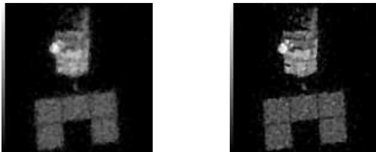
FIG. 10.5 – Objet restauré par estimation non myope (à gauche) et myope (à droite). Dans les deux cas, un a priori L_2L_1 et une contrainte de positivité objet sont utilisées. Les MSE à l'objet vrai sont de 0.45 et 0.39 photon respectivement
